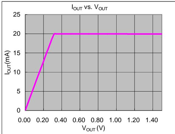
Fig. 3 I<sub>OUT</sub> vs. V<sub>OUT</sub> at V<sub>DD</sub>=5V
