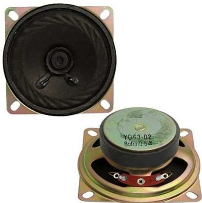
Акустический динамик RUICHI YD63-02 0.5Вт 8Ом – устройство, преобразующее электрические сигналы в звуковые, путём перемещения катушки с током в поле постоянного магнита с последующим преобразованием механических колебаний в колебания окружающего воздуха с помощью диффузора.
