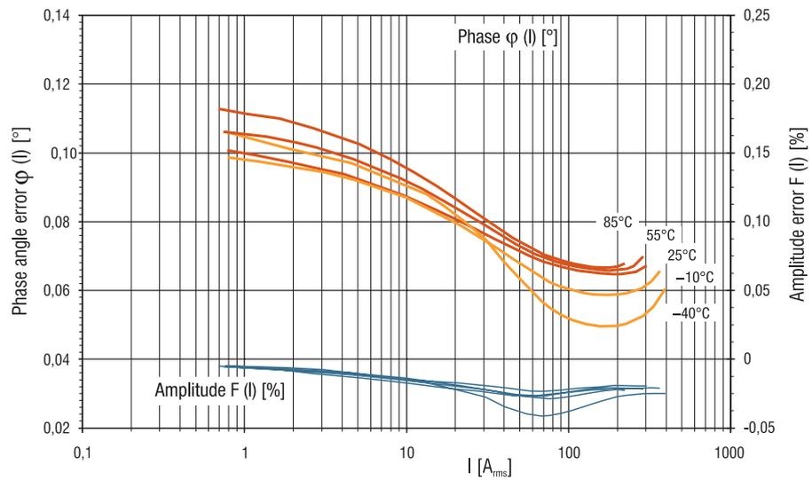
TYPICAL TEMPERATURE DEPENDENCE OF PHASE ANGLE AND AMPLITUDE ERRORS
